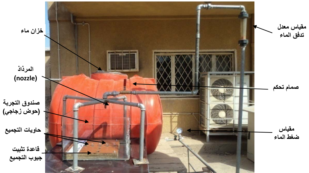
شكل رقم (١) يبين أجزاء شبكة الماء مع المرذاذ المربوط معها منظومة الفحص
