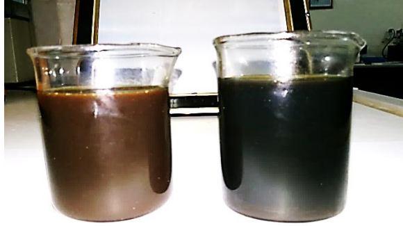
صورة (2) : المانع النانوي (المائل للجوزي الى يسار الصورة) وزيت التشحيم الخام .
