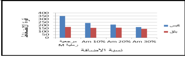
شكل (8) : يبين مقارنة قوة الانضغاط بطريقتي البثق والكبس بأضافة مخلفات البناء عند الحرق بدرجة (800 °C) لنماذج (M)
