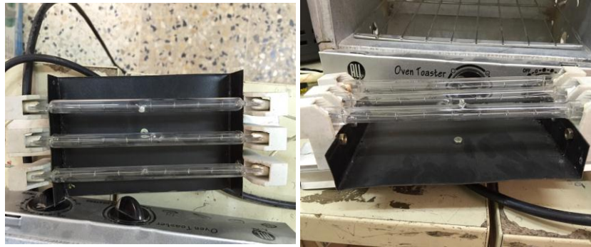
شكل رقم (1): مصابيح التسخين وطريقة تثبيتها على القاعدة
