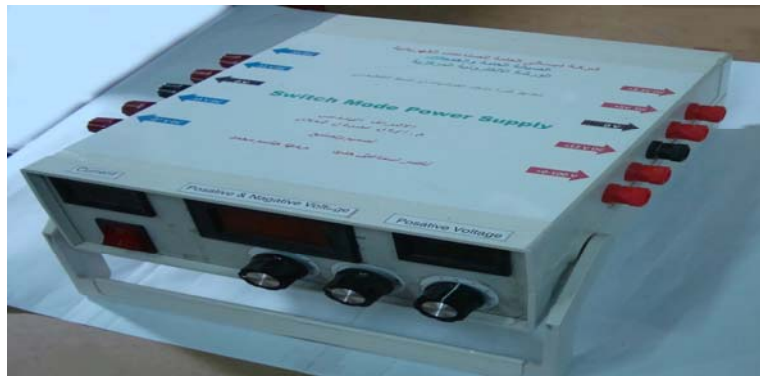
شكل رقم ( ١ ) المظهر الخارجي لمجهز القدرة متعدد الفولتيات ذو النمط التقطيعي
