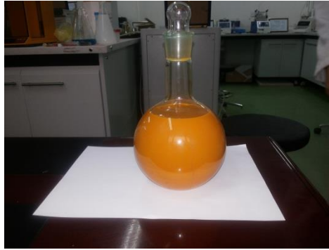
صورة (١): المائع النانوي لأوكسيد النحاس المحضر.
