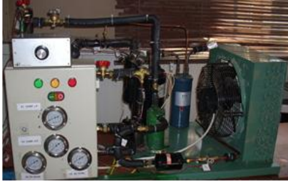
الشكل (٢) صورة فوتوغرافية لمنظومة التثليج التعاقبية الانية
