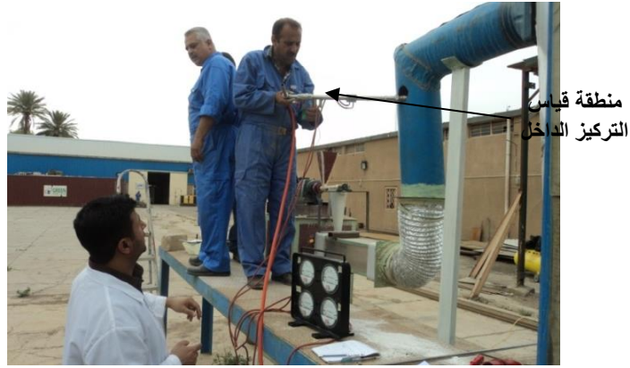
الشكل رقم (3) يبين نقطة القياس في مجرى الهواء الداخل إلى المرسبة
