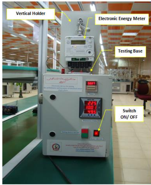
شكل ( ٢ ) صورة أمامية لجهاز فحص المقاييس الأحادية الطور الإلكترونية
