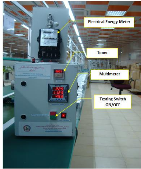
شكل ( ١ ) صورة أمامية لجهاز فحص المقاييس الأحادية الطور الكهروميكانيكية
