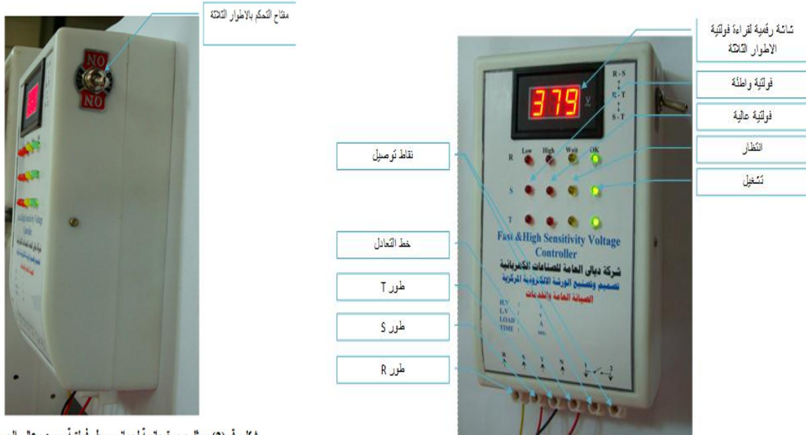
شكل رقم ( 1 ) يمثل صورة امامية لجهاز مسيطر فولتية سريع وعالي الحساسية ثلاثي الأطوار
