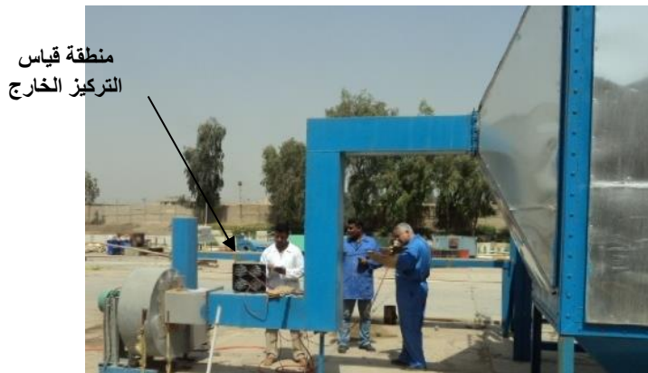
الشكل رقم (4) يبين نقطة القياس في مجرى الهواء الخارج من المرسبة
