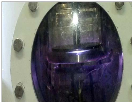
الشكل (٧) صورة البلازما المتولدة داخل المنظومة
