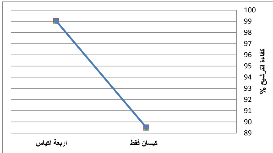
الشكل (2) يبين علاقة كفاءة الترشيح مع عدد الأكياس
