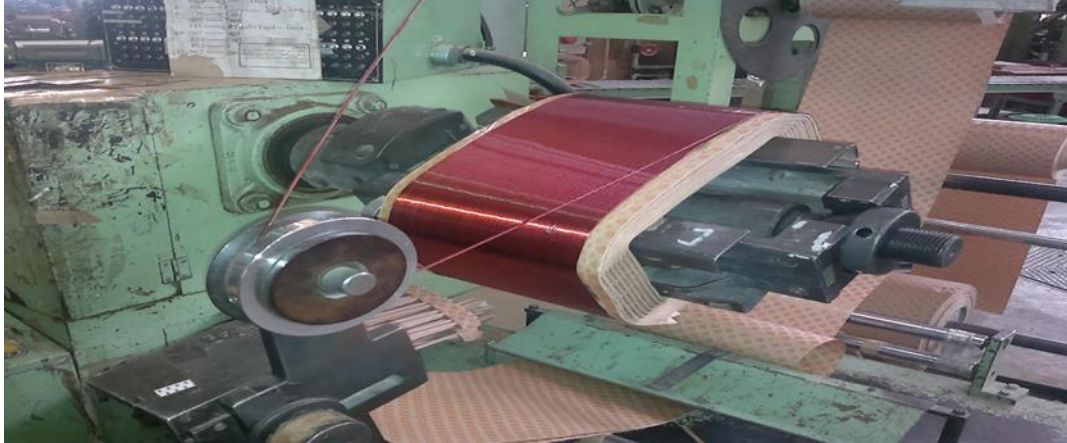
الشكل رقم (6) يبين طريقة لف ملف الفولتية العالية (HV Coil) معمل المحولات شركة ديالى
