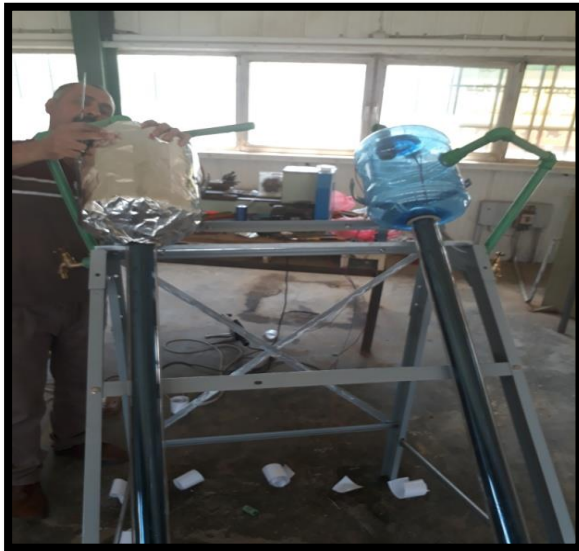
شكل (٤) : عزل الخزان بالصوف الزجاجي
