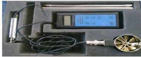
الشكل (١٠) جهاز قياس سرعة تدفق الهواء الرقمي
