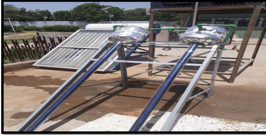
شكل (١) : منظومتي الانبواب الزجاجي ذو الانبواب النحاس والانبواب التقليدي
