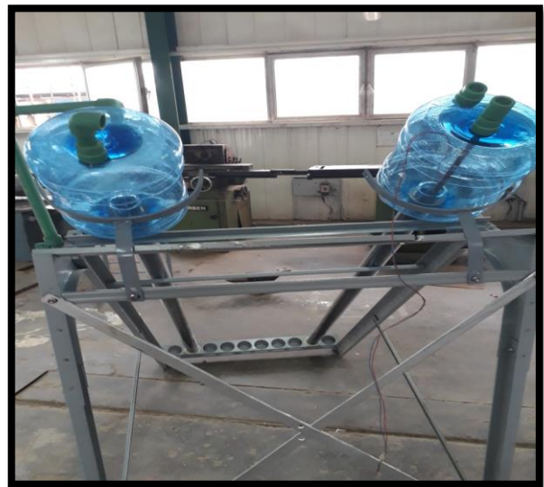
شكل (٣) : تثبيت الانابيب على الحامل الحديدي
