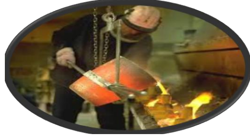
شكل رقم (٧) : صورة طريقة صب الأشجار السيراميكية
