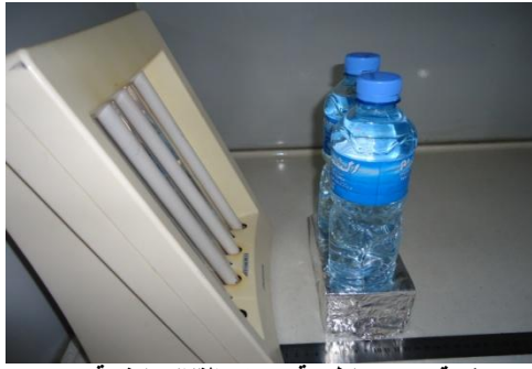
صورة رقم (1): منظومة تعرض القناني لاشعة UV-A
