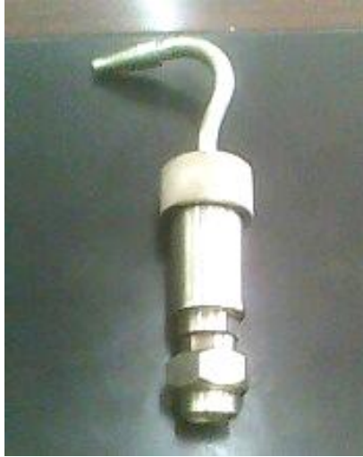
الشكل رقم (9) : يبين صورة حجرة اخذ النموذج (المرذاذ مع الحاوية والمرشح)
