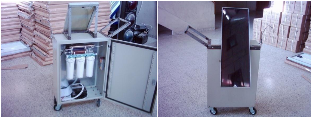
شكل رقم ( 3 ):منظومة التحلية والتعقيم الشمسية
