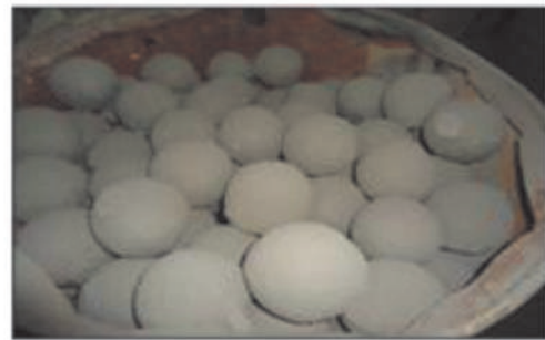
الشكل (5) كرات طاحنة للسمنت قبل التنظيف
