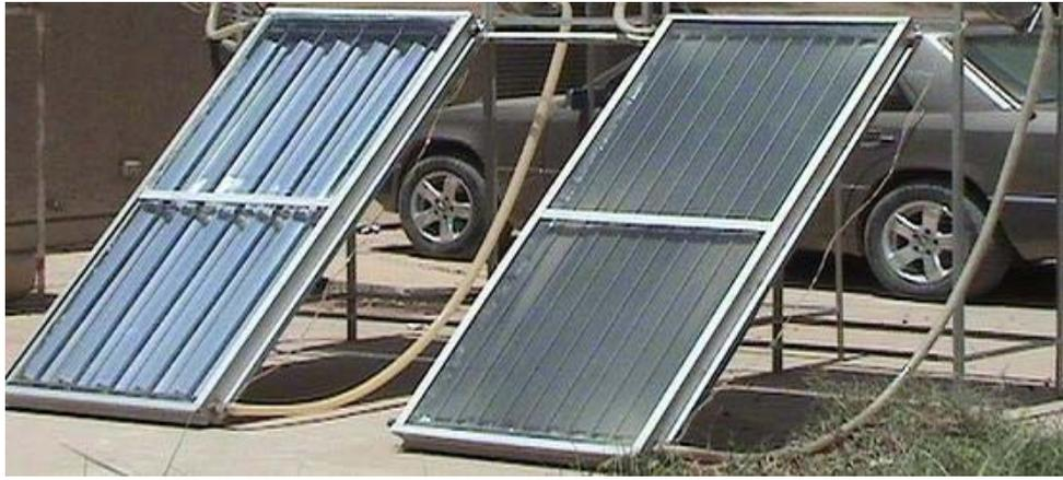
( الشكل رقم ١ ) المجمع الشمسي المسطح التقليدي والمجمع ذو المركز الشمسي
