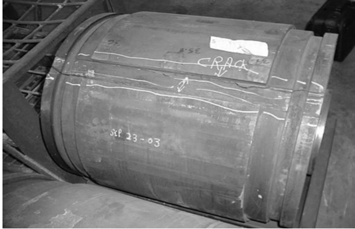
شكل رقم ( ١ ) حاوية يظهر فيها آثار شقوق في المناطق الضعيفة من السطح الخارج
